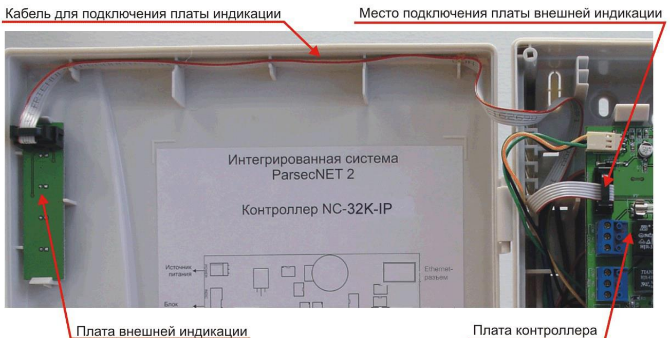
Рисунок 28. Схема подключения платы внешней индикации
