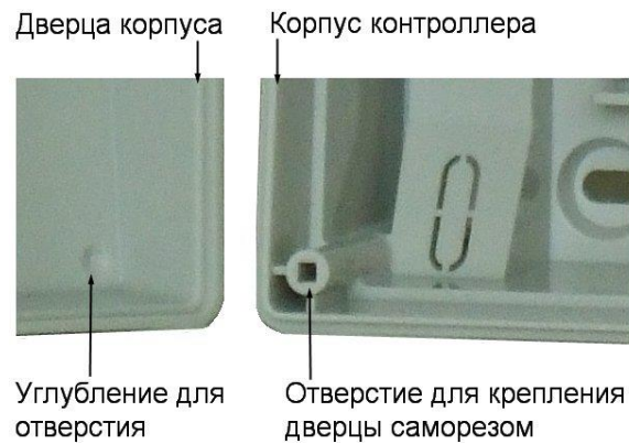
Рисунок 5. Схема «жесткого» крепления дверцы к корпусу контроллера
