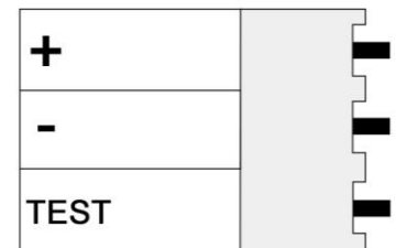
Рисунок 3. Назначение контактов разъема POWER
