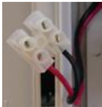
Рисунок 10. Кабель для подключения замка к блоку питания
