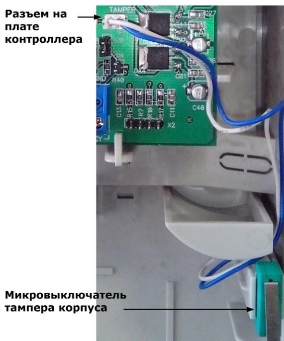
Рисунок 24. Подключение тампера корпуса
