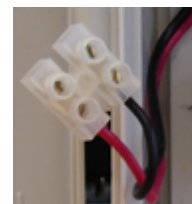
Рисунок 10. Клеммы для подключения замка к блоку питания
