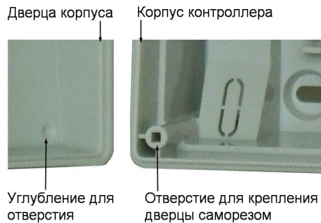
Рисунок 5. Схема «жесткого» крепления дверцы к корпусу контроллера
